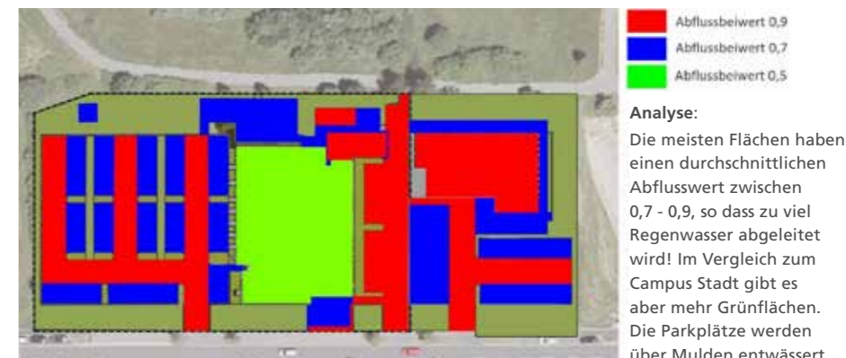
Abbildung 12: Flächenversiegelung – Campus Aspach
