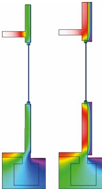
Viviendas en Temuco, en el marco del Plan de Desccontaminación Ambiental (PDA), imagen de la izquierda sin aislación, a la derecha con aislación incorporada.
